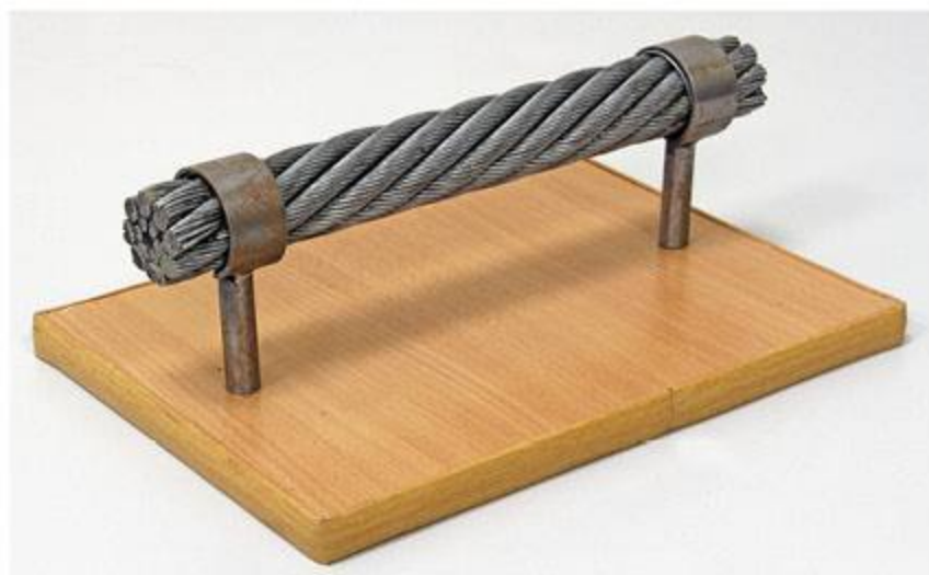
Фрагмент троса аэрофинишёра ТАВКР «Адмирал Флота Советского Союза Кузнецов» Изготовлен АО «Северсталь канаты», филиал «Волгоградский» Волгоград, начало XXI века Поступил в дар от руководителя Военно-морского музея Краснознаменного Северного флота В.Г. Чушенкова
